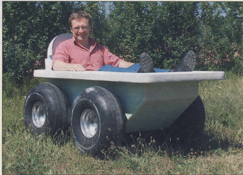
Das „SplashCar“ ist ein geländegängiges und schwimmfähiges Elektrofahrzeug in Leichtbauweise (Bild: IKV/AVK e.V.)
