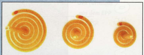
Ermittelte Fließweglängen im Spritzgussverfahren
