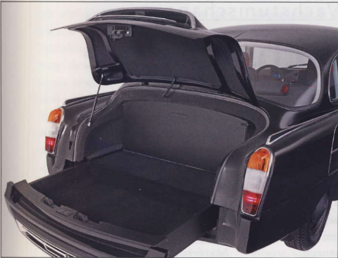
Ein ausziehbarer Kofferraum wertet unter anderem das Fahrzeug auf Basis des Tatra-Modells von 1972 auf und demonstriert die neuen Möglichkeiten modernen Kunststoff-Leichtbaus
