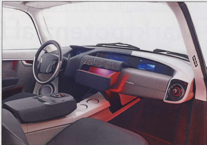
Beim Airbagsystem der Instrumententafel des Premium Attitude werden herkömmliche Metall- oder Hartkunststoffabdeckungen durch Formteile aus Weichschaum- und Maschengewebe ersetzt
