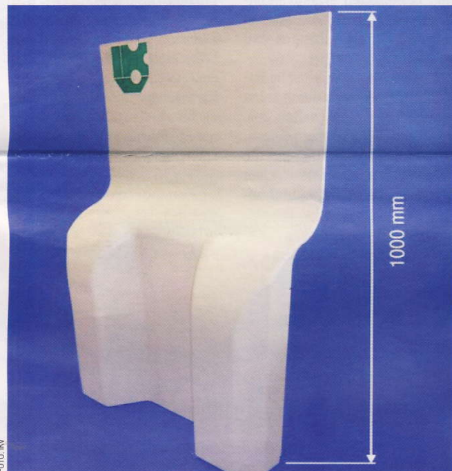
Ein großflächiges Demonstrator-Formteil aus Thermoplast-Composite mit CBT-Matrix
