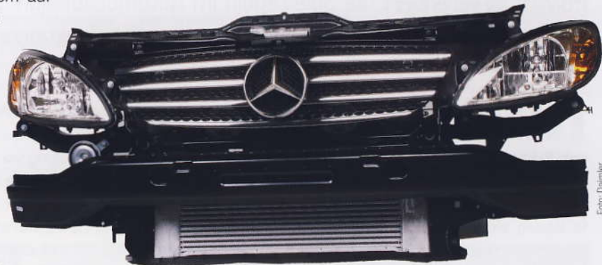
Der Thermoplast Celstran LFT absorbiert Energie und ist deshalb sehr gut für das Frontend geeignet.
