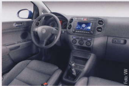
Golf-Dashboard aus Celstran: 0,5 mm weniger Material gleich 20 Prozent weniger Gewicht!
